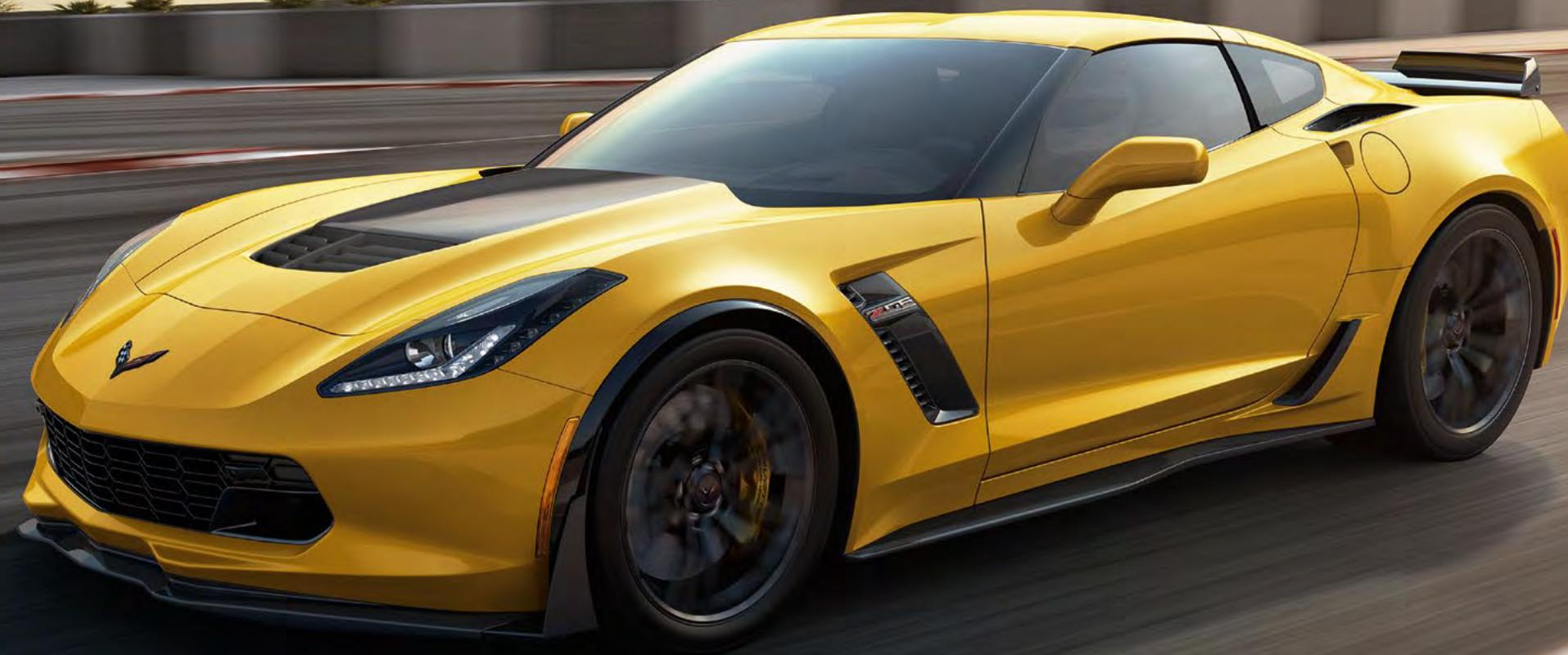
DIE Z06, GEMEINSAM MIT DEM CORVETTE RENNWAGEN C7.R ENTWICKELT, IST DIE SCHNELLSTE UND LEISTUNGSSTÄRKSTE SERIEN-CORVETTE ALLER ZEITEN. DIESER SUPERSPORTWAGEN PRÄSENTIERT SICH MIT EINEM STABILEN LEICHTBAU-ALUMINIUMRAHMEN UND EINEM 6,2-L-V8-ALUMINIUM-KOMPRESSORMOTOR MIT BEEINDRUCKENDEN 659 PS (485 KW) UND 881 NM DREHMOMENT.<sup>1</sup>
